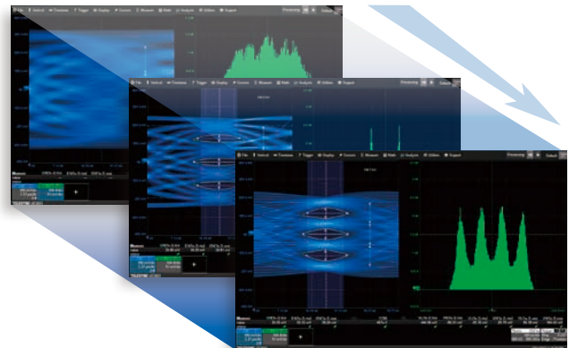
CTLEの最適化 — OIF CEI-56G-VSR-PAM4遠端EyeテストのためのCTLEピーキング値を自動的に最適な設定を行います。0dB、3.5dB、6dBピーキングのEyeのスクリーンショットを表示
