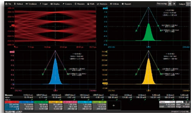
ジッタテスト — ジッタテスト各Eyeの非相関ジッタ(UJ)分布を表示し、PAM4規格において定義されたジッタ成分を計算するのに使用
