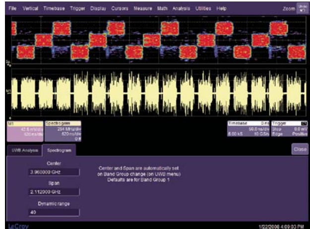
スペクトログラム表示：TFC1の信号が3つのバンドをホッピングしているのが分かります
