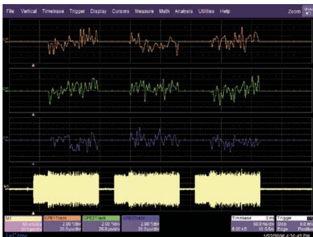
Common Phase Error (CPE)表示：各シンボルのCommon Phase Errorの変動を示しています。
