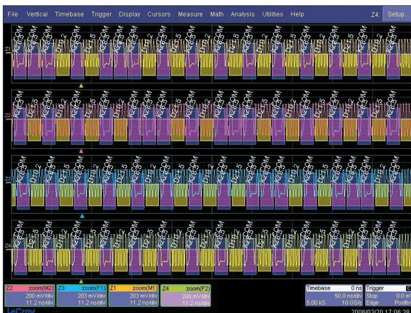
PCI Expressの4レーンの信号を同時にデコードした例
