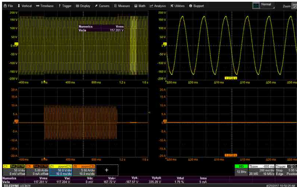
図 9: パンが焼きあがって無負荷に戻った時の交流ライン計測結果
