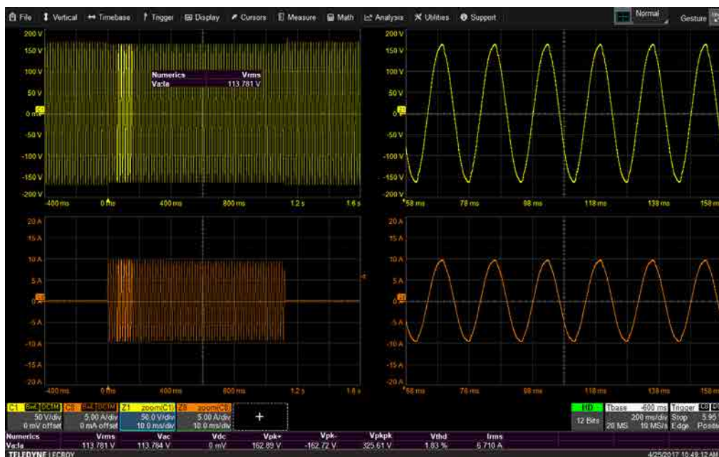
図 8：交流ライン計測結果はトースターがパンを焼いて電流が流れた時に起きる電圧降下(117.2 V → 113.7 V)をはっきりと示します。
