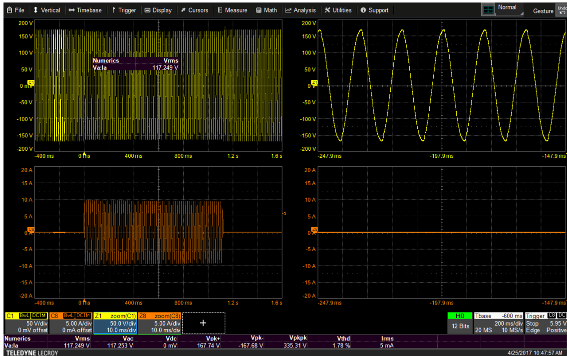
図 7：左上に示した、無負荷からトースターを負荷にして、再び無負荷に戻した2秒間を捕捉した波形を用いたライン電圧の交流ライン計測結果。2秒間で捕捉した電流波形は左下に示され、電圧と電流波形の拡大表示がそれぞれ右側に示されています。
