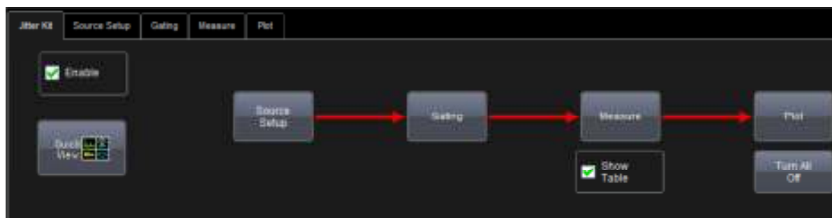
Jitter Kit メイン・ダイアログ (ジッタ解析の基本フロー)
