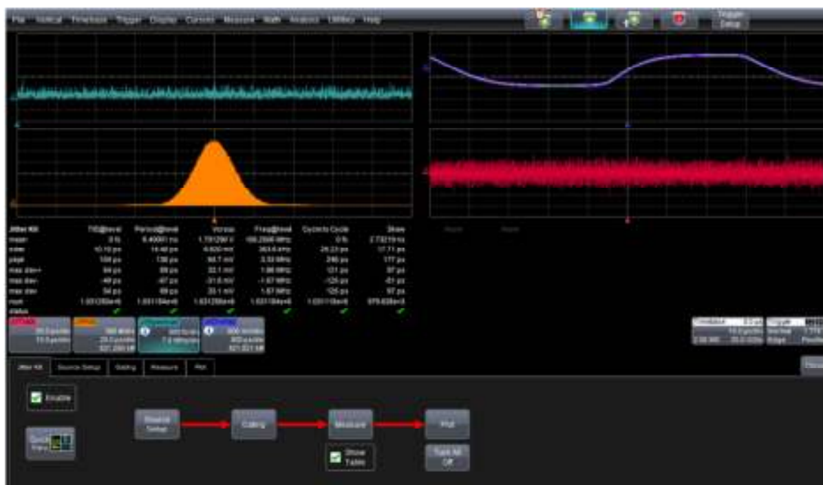
Jitter Kit はジッタが含まれている 156.25MHz の差動クロック信号を計測し、時系列でのジッタ表示、ジッタの周波数成分、統計表示、ジッタ・オーバーレイ表示をしています。
