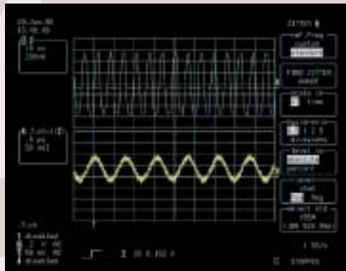
ジッタ関数を使って、クロック信号の周期的ジッタを解析した例
